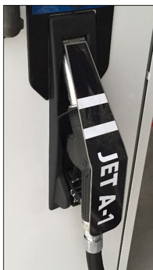
Figura 1 Esempio di rivestimento di una pistola di rifornimento con la scritta Jet A-1
