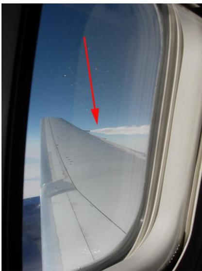
Les avions ne peuvent excéder un certain poids au décollage et à l'atterrissage. À l'atterrissage, le poids limite est déterminé de telle manière que l'appareil résiste à un atterrissage brutal et soit en mesure de s'arrêter sur la distance prescrite.
