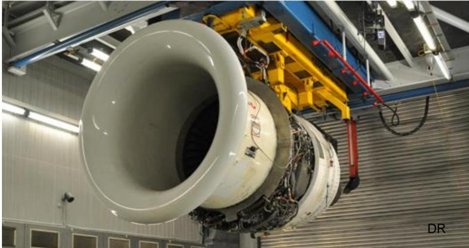
Illustration : le réacteur test et sa sonde de gaz d'échappement rétractable (à l'arrière) utilisée pour mesurer les particules fines.
