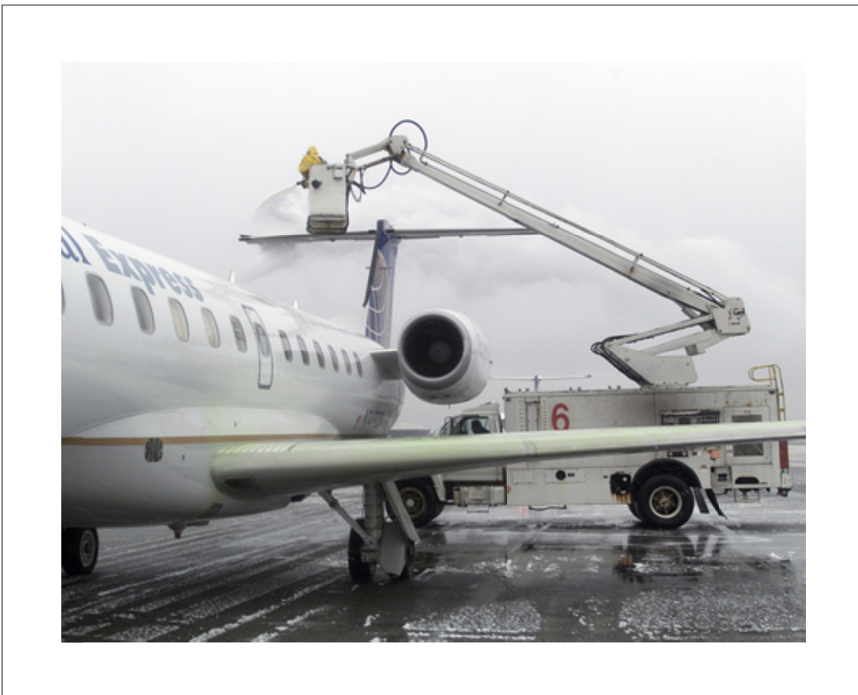
Figure III-10-1. Matériel classique de dégivrage/d'antigivrage au sol (Image reproduite avec l'aimable autorisation de la NASA)
