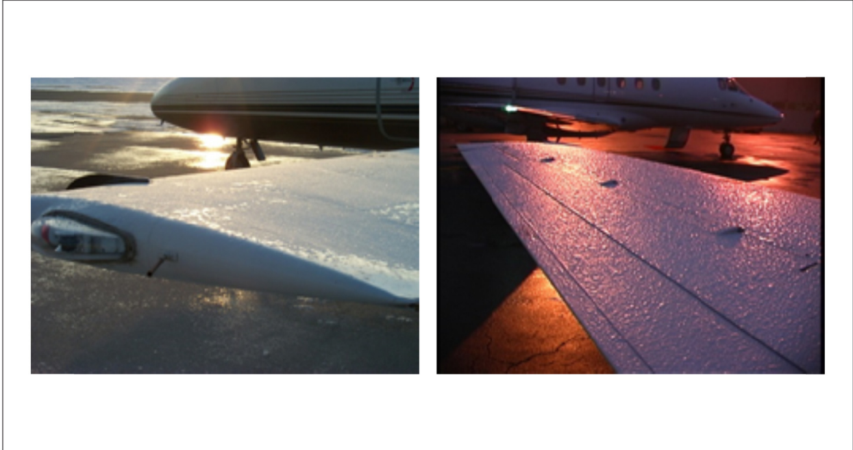
Figure II-1-1. Exemples de givrage sur les surfaces d'un avion (Images reproduites avec l'aimable autorisation de la NASA)
