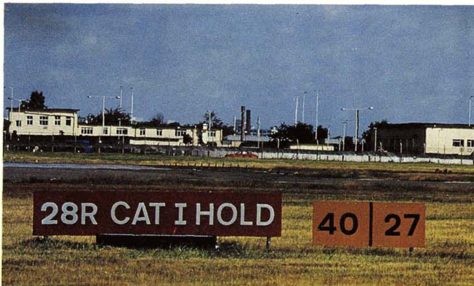
Figure A-2.— Panneau indicateur de point d'attente de catégorie I et panneau d'indication situés côte à côte
