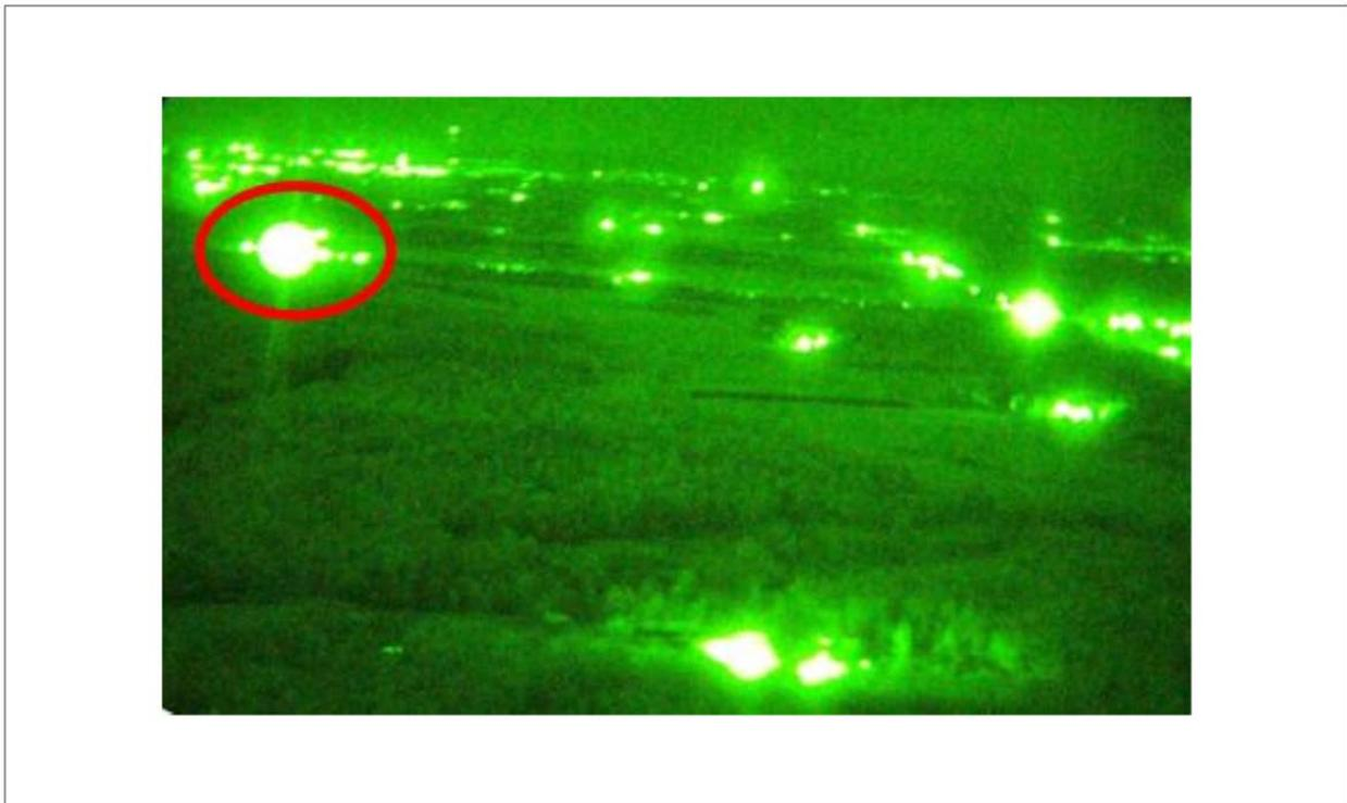
Figure 12-17. Feu d'obstacle (entouré) vu à travers des lunettes de vision nocturne (source : Conseil national de recherches du Canada)
