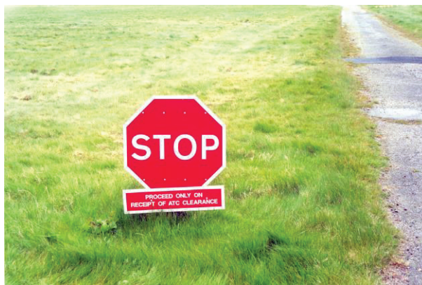
Figure 12-4. Panneau de point d'attente sur voie de service
