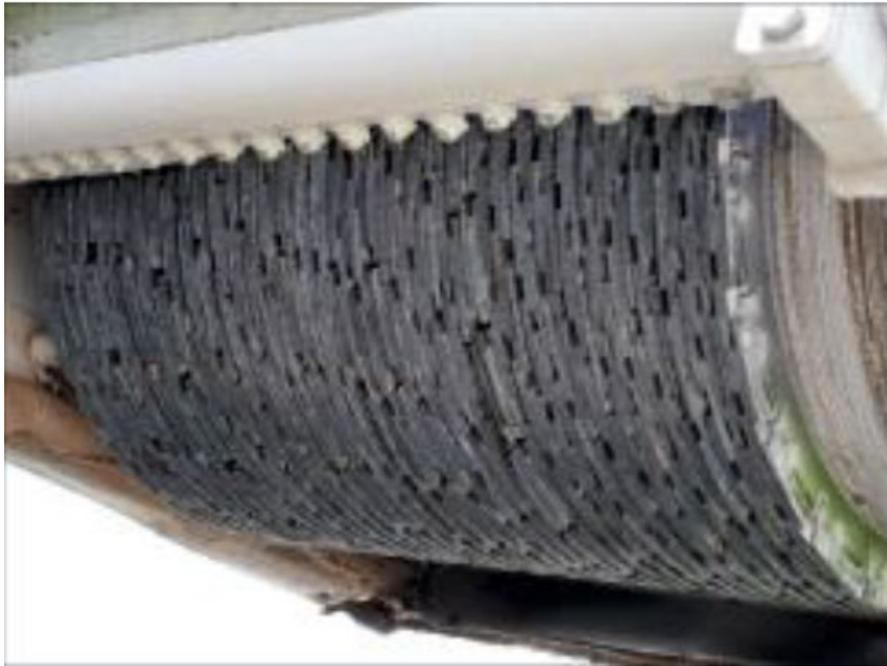
Figure A6-8. Meulage au diamant du béton de ciment
