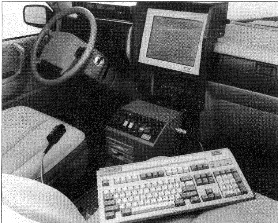
Figure 5-7. Système d'affichage fluorescent à vide et clavier pour le dispositif de mesure du frottement sur les pistes
