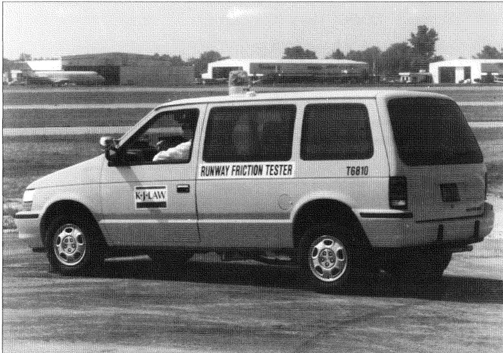
Figure 5-6. Break utilisé pour le dispositif de mesure du frottement sur les pistes
