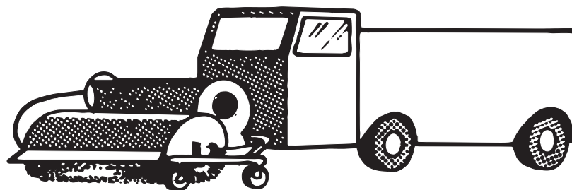
Grosse balayeuse poussée (brosse de plus de 3,6 m) avec deux moteurs et souffleuse à l'avant — cabine classique
