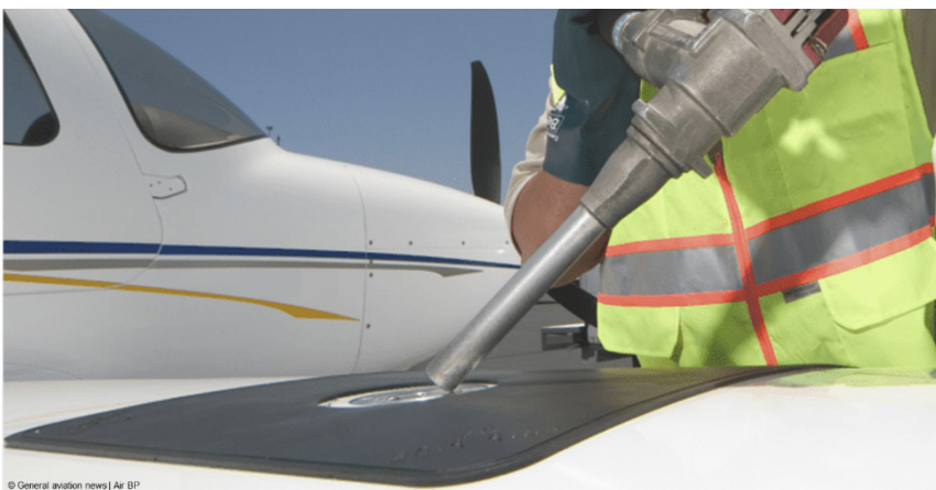
Silikonmatte zum Schutz der Tragfläche beim Betanken
