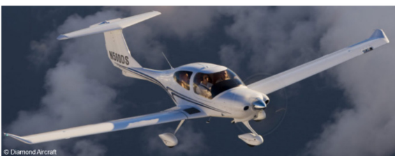
Diamond DA40 XLT mit Kolbenmotor (AvGas 100LL)
