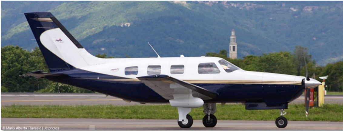
Piper Malibu Mirage (PA46-350P) mit Kolbenmotor (AvGas 100LL)
