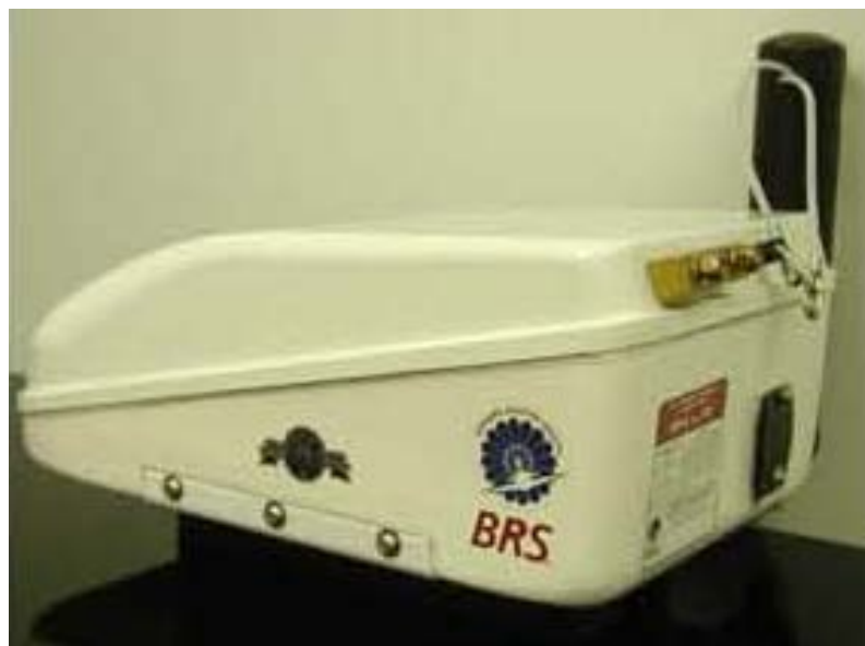
Abbildung 7: Fallschirm in quaderartigem Container verpackt (VLS)
