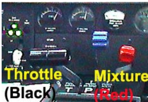
Bild 2: Gashebel (schwarz), Propellerverstellung (Blau) und Gemischhebel (Rot).
