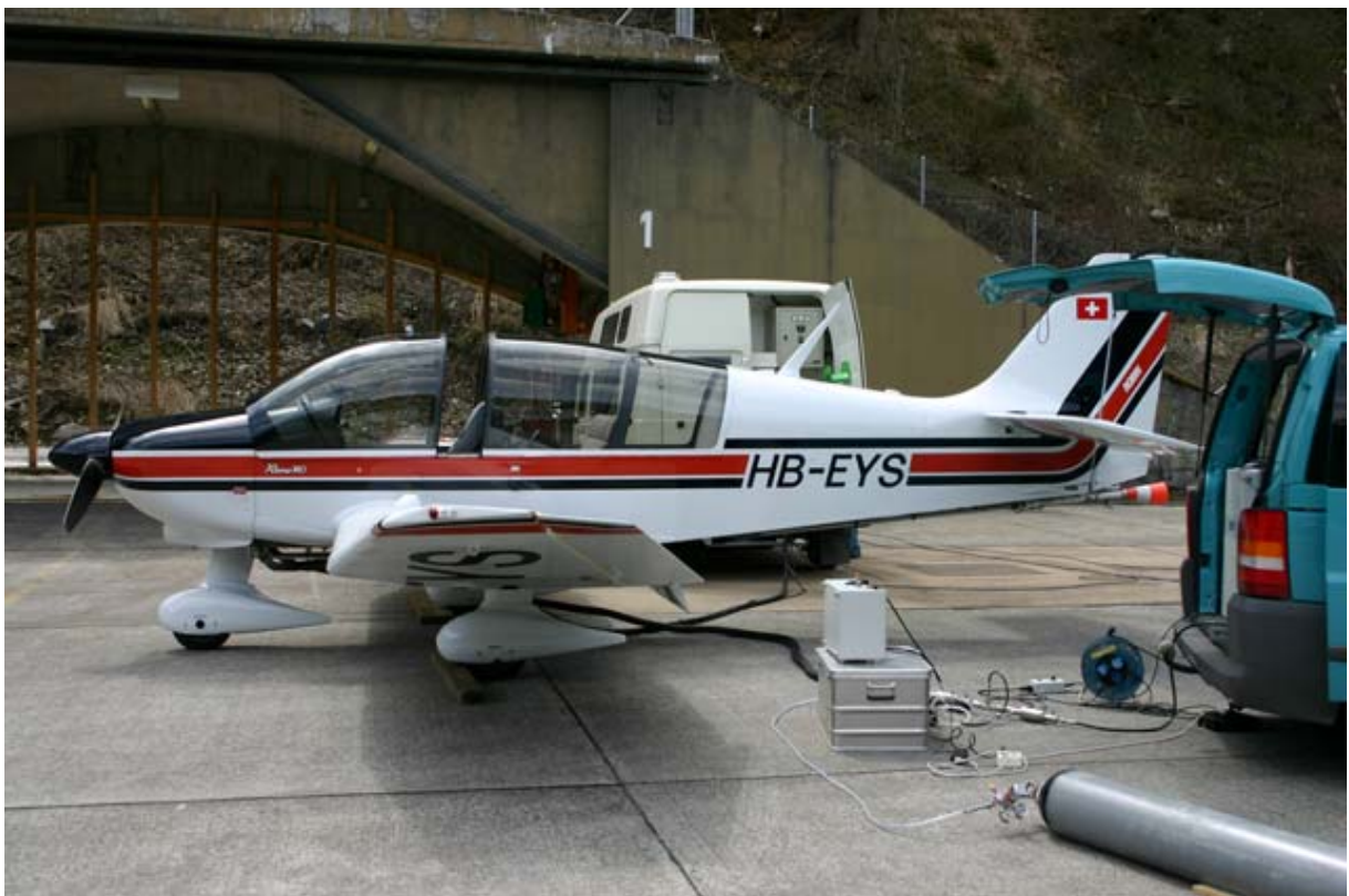
Bild 4: Abgasmessungen, Partikelmessungen, Treibstofftests und Untersuchungen der Gemischeinstellung mit der Robin DR48, HBEYS, Lycoming O-360 Motorenserie.
